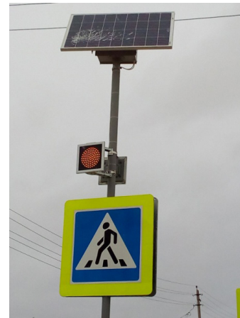
Рис. 4. Светофор, работающий на солнечной энергии
